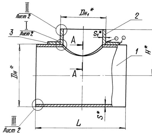
Тройник сварной переходной ТС 589.000 СБ выпускается на рабочее давление 4,0 МПа; 2,5 МПа;
