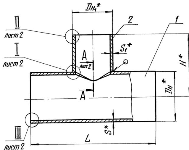
Тройник сварной переходной ТС 588.000 СБ выпускается на рабочее давление 4,0 МПа; 2,5 МПа; 1,6 МПа; 1,0 МПа; 0,63 МПа; 0,40 МПа.
